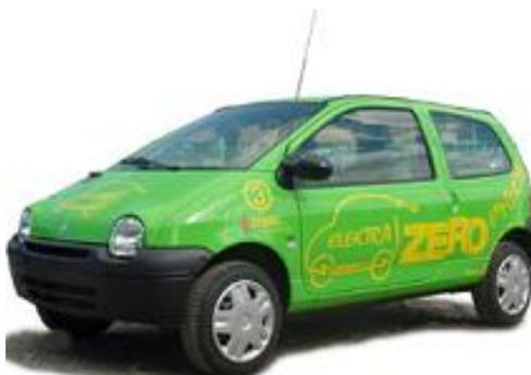
**Figura 11** - Veículo Twingo, eletrificado pela MES-DEA
