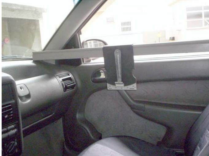
**Figura 22** - Dispositivo adaptado para medição de inclinações
