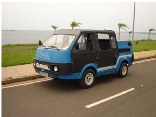
**Figura 3:** Veículo elétrico Itaipu E-400
