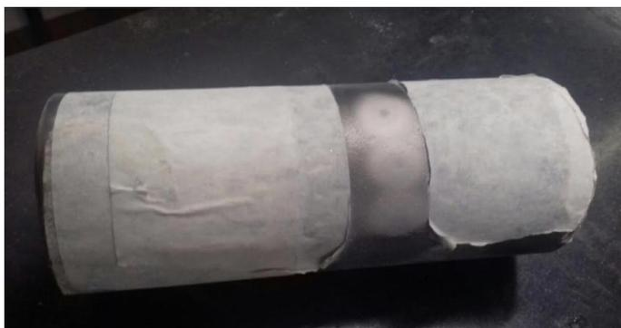
Figura 31: Aspectos obtidos para os pontos jateados em tubulação revestida com carboneto de tungstênio. Amostra cedida pelo CEPTEL.
