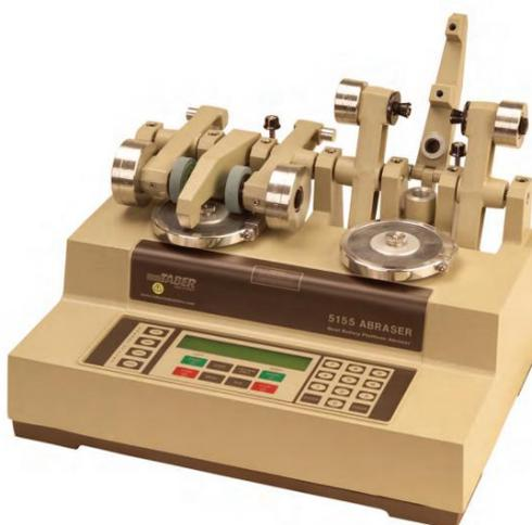
Figura 16: Table abraser – equipamento de abrasão utilizado neste trabalho.
