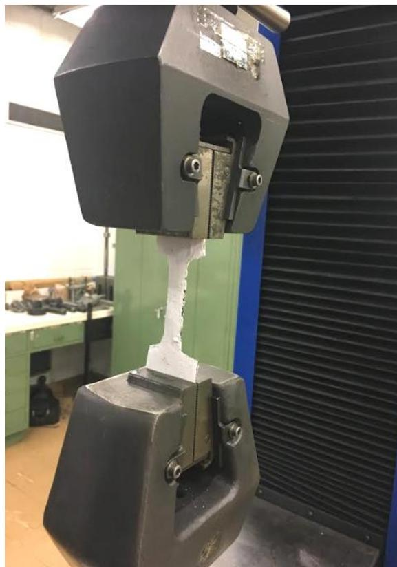
Figura 33: Ensaio de tração feito apenas no revestimento.
