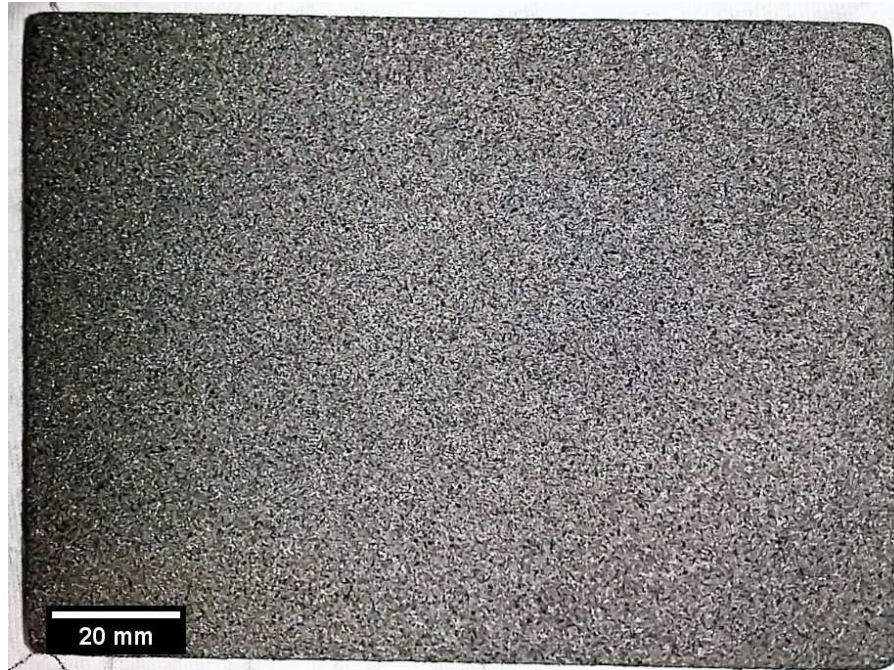
Figura 33 – Substrato preparado para aspersão térmica.
