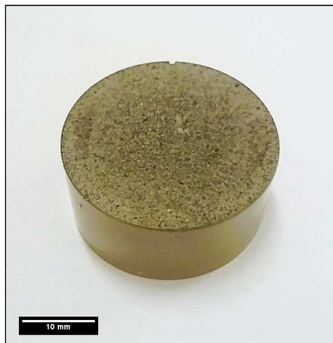
Figura 13 – Cinzas embutidas em resina acrílica.
