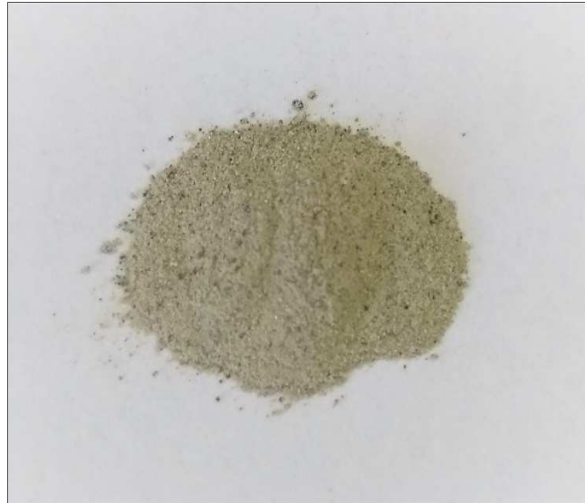
Figura 12 – Cinzas coletadas de caldeira em funcionamento no Brasil.
